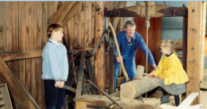
Oder schauen Sie dem Hausherrn beim Sägen von Baumstämmen über die Schulter. Das **Einspanner-Sägewerk** stammt noch aus dem **18. Jahrhundert** und wird kraftvoll über ein **Wasserrad** betrieben.
